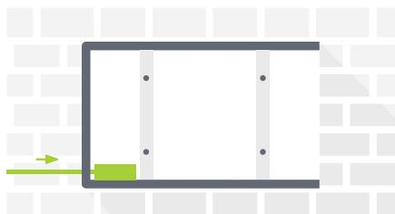
**5** V libovolném místě vyvrtáme otvor, protáhneme napájecí kabel a zapojíme.
